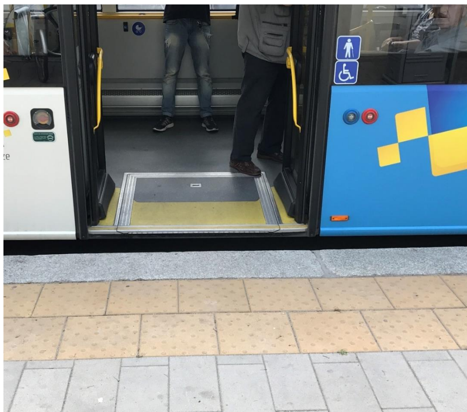
Rys. 9.3 Zminimalizowana przerwa między peronem przystankowym a autobusem
