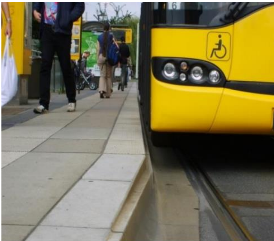
Rys. 9.2 Zalecane ukształtowanie podniesionej krawędzi peronowej – wyrównanie z pierwszymi stopniami w autobusie
